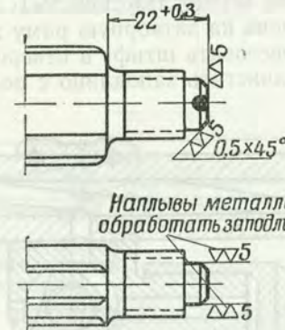
Рис. 140. Обработка переднего конца затворной рамы
