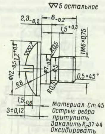
Рис. 21. Винт (1-69) защелки
