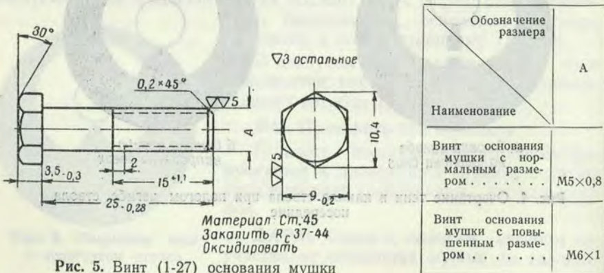
Рис. 5. Винт (1-27) основания мушки
